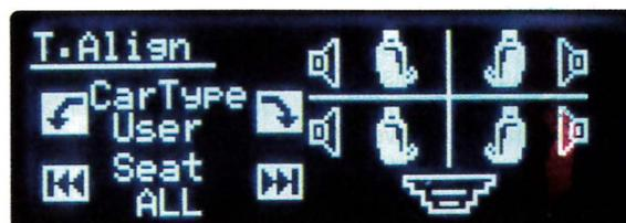
Ecco come si presentano le schermate relative al setup dell'allineamento temporale: si può scegliere un tipo di macchina per avere delle distanze dalle quali partire nella messa a punto, si può scegliere per quale specifico sedile fare la regolazione così da avere una ulteriore impostazione di base delle distanze e poi si passa alla regolazione fine delle distanze per il singolo canale.
